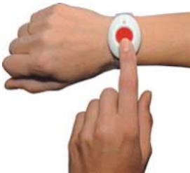
Nachdem der Alarm ausgelöst wurde, kann man über die Freisprech-einrichtung der Basisstation mit den Mitarbeiterinnen und Mitarbeitern der Rettungsleitzentrale sprechen, ohne den Telefonhörer abnehmen zu müssen (z. B. nach einem Sturz).
