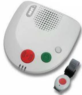
Die Basisstation des Rufhilfegerätes, die an die Telefonleitung (Festnetz) angeschlossen wird, wählt automatisch die Rettungsleitzentrale des Roten Kreuzes an, wo auf einem Bildschirm der Name und die Adresse des Alarmauslösers aufscheinen.
